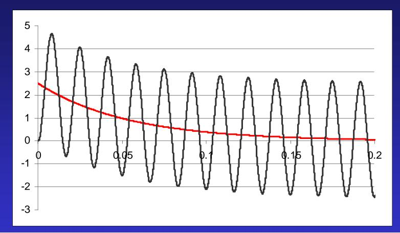
$$i(t) = \frac{V_{m}}{Z} \left[ \cos(\omega t + \alpha - \theta) - \cos(\omega t_{0} + \alpha - \theta) e^{-R\omega t/X} \right]$$
