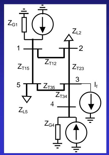
$$Z_{\text{bus}} = \begin{bmatrix} Z_{11} & Z_{12} & Z_{13} & Z_{14} & Z_{15} \\ Z_{21} & Z_{22} & Z_{23} & Z_{24} & Z_{25} \\ Z_{31} & Z_{32} & Z_{33} & Z_{34} & Z_{35} \\ Z_{41} & Z_{42} & Z_{43} & Z_{44} & Z_{45} \\ Z_{51} & Z_{52} & Z_{53} & Z_{54} & Z_{55} \end{bmatrix}$$
