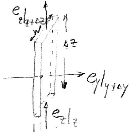
$$(\Delta z W e_y|_y) - (\Delta z W e_y|_{y+\Delta y}) + (\Delta y W e_z|_z) - (\Delta y W e_z|_{z+\Delta z}) + (\Delta y W \Delta z) p g_z v_z = 0$$
