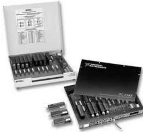
Fig. 5.8. NI-DAQ, Model SC-2345 [17].
